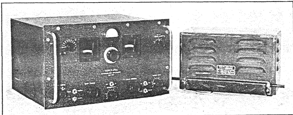
Fig 2. Så här ser mottagaren till spolsystemet i fig 1 ut. Den heter SP-110SX (S för frekvensområde till 40 MHz, X för kristallfilter). Lådan till höger är likriktaraggregat. Mottagaren kostade 1937 435 dollar i USA enligt vad en annons i det årets Radio Amateur's Handbook uppger. Uppbyggnad: två avstämde HF-steg, avstämt blandarsteg samt 3 MF-steg. Beat-oscillator. I övrigt inget märkvärdigt schemamässigt sett. Mottagarens storhet ligger i sättet för uppbyggnaden. Svenskarna försökte sedermera kopiera mottagaren, men lyckades inte nämnvärt bra.
